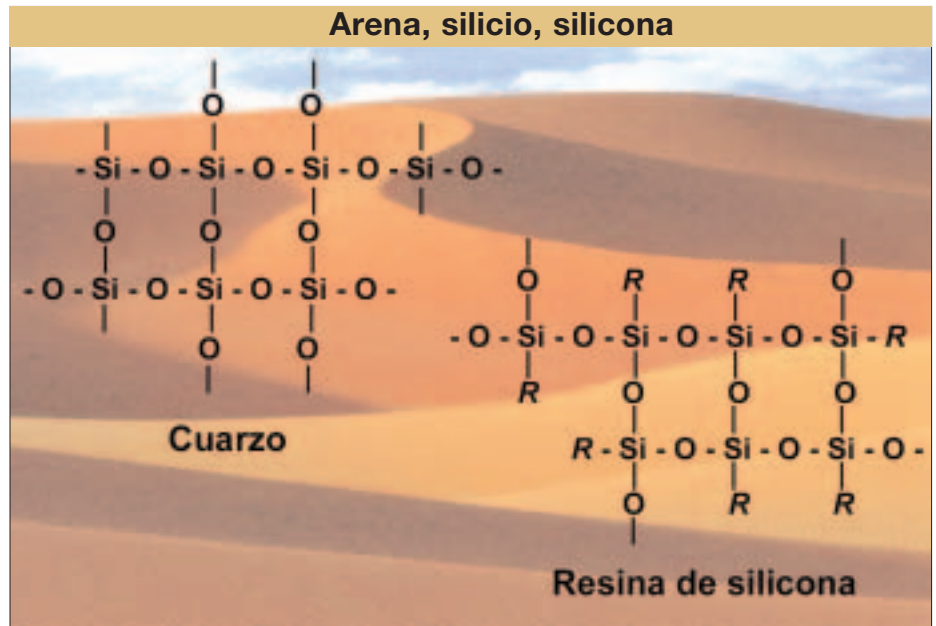
Figura 1: Estructura con reticulación tridimensional de mineral de cuarzo natural comparada con el enrejado o red tridimensional de resina de silicona ( estructura de cuarzo modificada orgánicamente )
